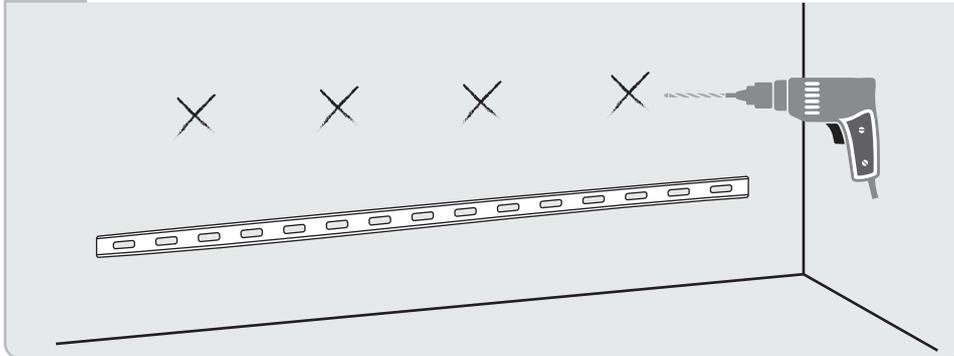
Achten Sie hierbei darauf das die Bohrungen Wegerecht sind und mit den Öffnungen der Schiene übereinstimmen. Verwenden Sie hierbei eine Wasserwaage.
